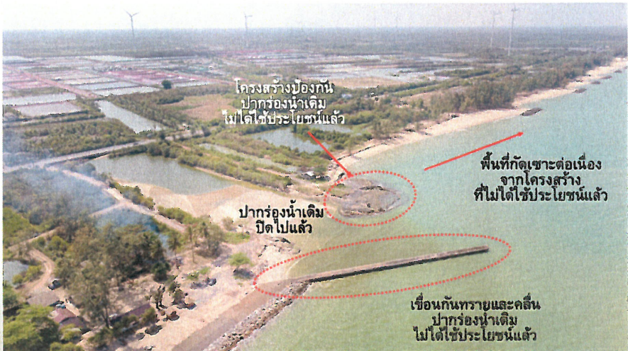
โครงสร้างปากร่องน้ำเดิมที่ไม่ได้ใช้ประโยชน์แล้ว ขนาบนาท จ.นครศรีธรรมราช
