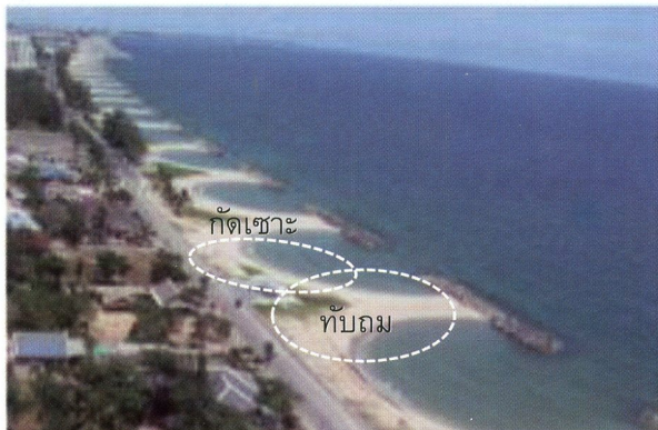
รูปที่ 5 ผลกระทบของเขื่อนกันคลื่น ณ หาดแสงจันทร์ จ.ระยอง
